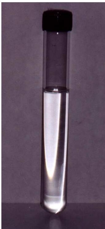
**Figura 28:** Solução 9% de caramelo após clarificação em colunas de Amberlite IRA-96-SB e Amberlite 252-Na, ligadas em série.
