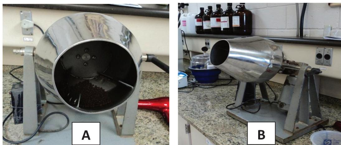
**Figura 1.** Sistema de revestimento da ração por aspersão (A) vista frontal e (B) vista lateral.
