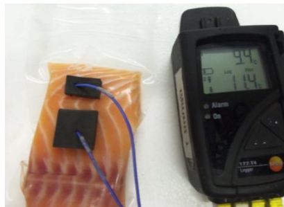
Figura 3.5 – Instalação dos sensores no produto para monitoramento da temperatura da superfície e interna do salmão.
