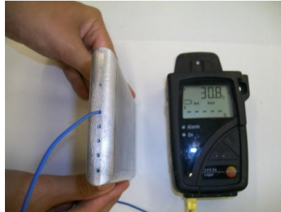
Figura 3.2 – Corpo de prova de alumínio utilizado para o teste de aquecimento.
