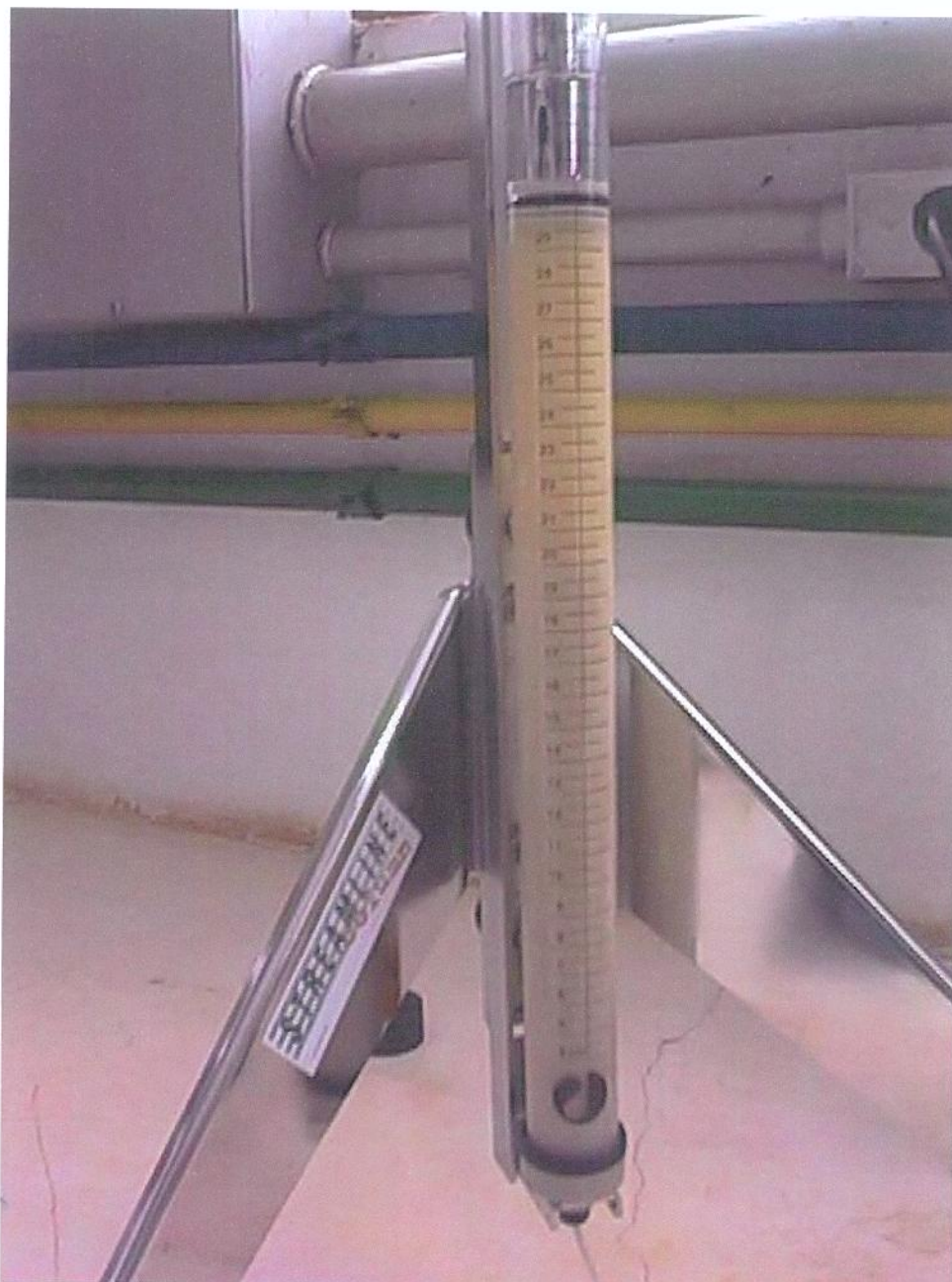
Figura 4.40: Leito expandido com resina Streamline SP, operando para purificação da enzima inulinase a partir de caldo não clarificado (com células de Kluyveromyces marxianus )
