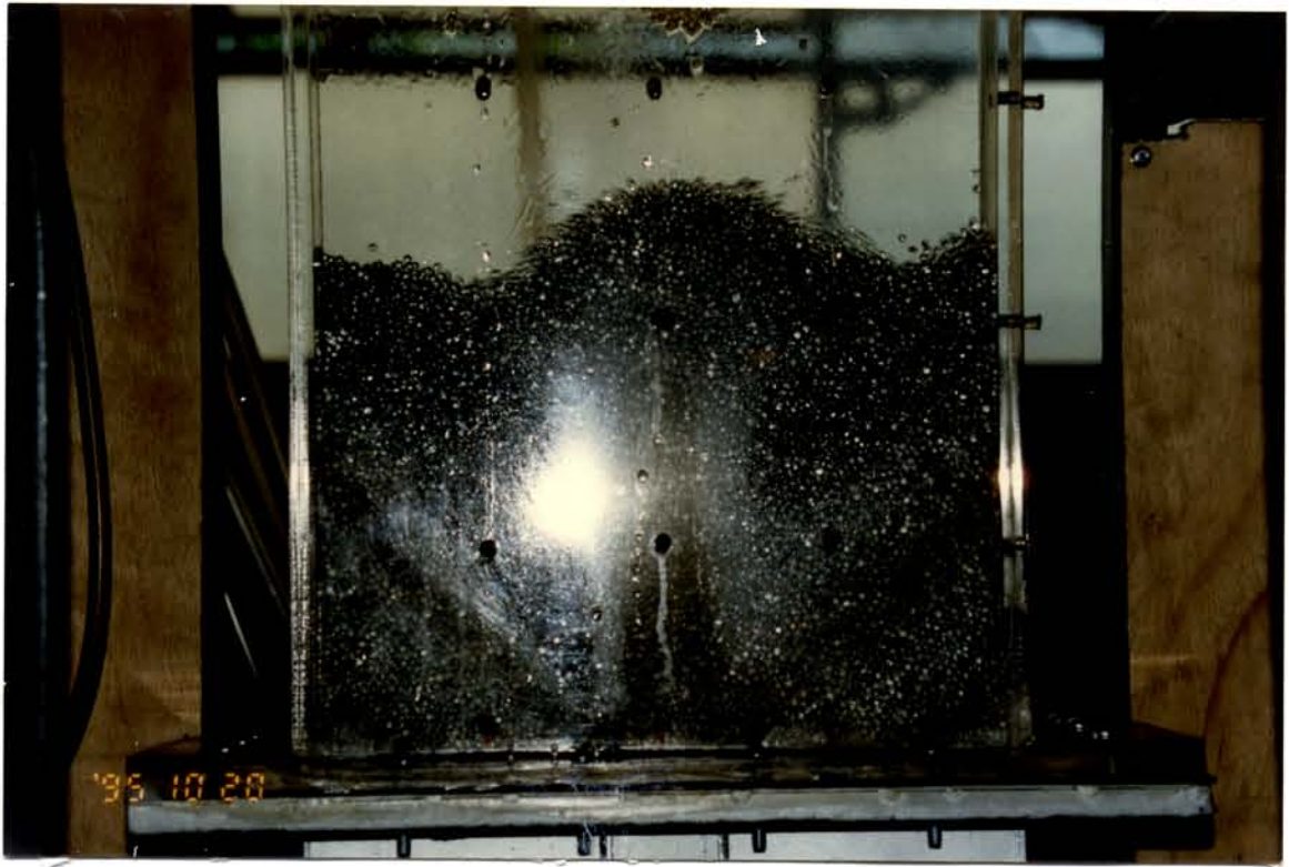
Figura 4.4 Jorro Convencional ( Vazão no jorro = 2.33 \cdot 10^{-2} \text{ m}^3 / \text{s} ( 9,30 m / s))
