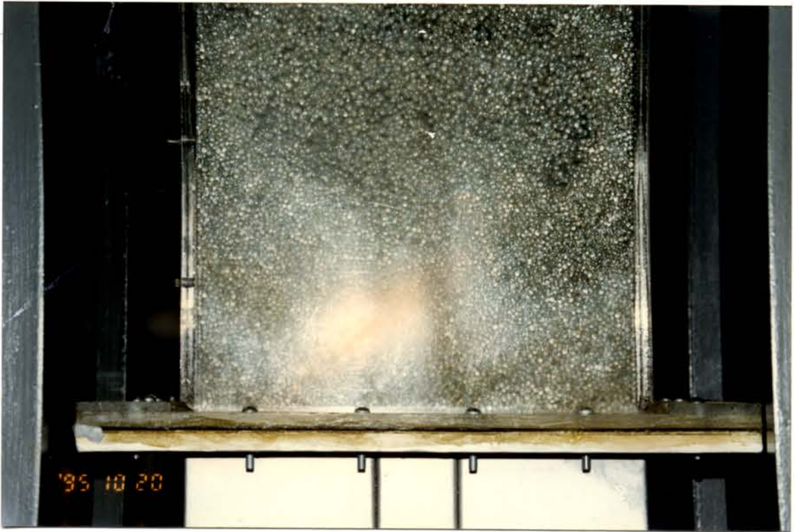
Figura 4.8 Jato em Leito Fluidizado ( Vazão no jorro = 2,33 \cdot 10^{-2} \text{ m}^3 / \text{s} , ( 9,30 \text{ m} / \text{s} )), ( Vazão Ânulo = 2,05 \cdot 10^{-2} \text{ m}^3 / \text{s} ( 1,67 \text{ m} / \text{s} )).
