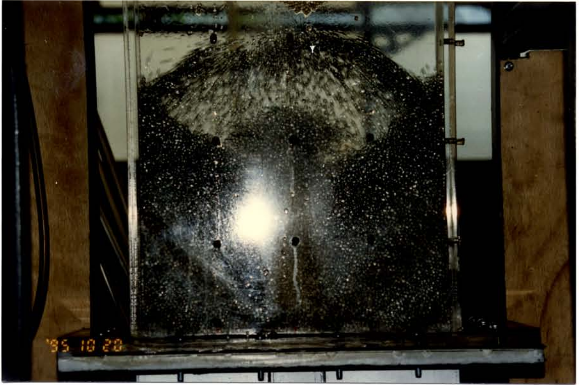
Figura 4.6 Jorro Fluidizado ( Vazão no jorro = 2,33 \cdot 10^{-2} \text{ m}^3 / \text{s} ( 9,30 m / s)), ( Vazão Ânulo = 1,15 \cdot 10^{-2} \text{ m}^3 / \text{s} ( 0,92 m / s)).
