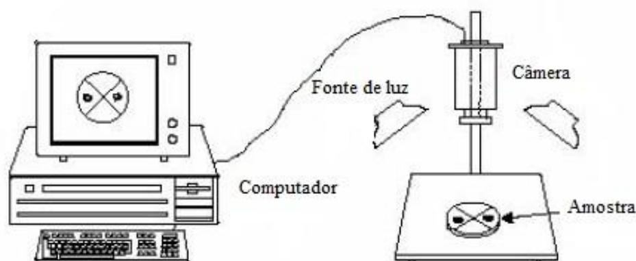
Figura 4- Modelo de sistema por imagem de alimentos. Adaptado de Wang e Sun (2002).
