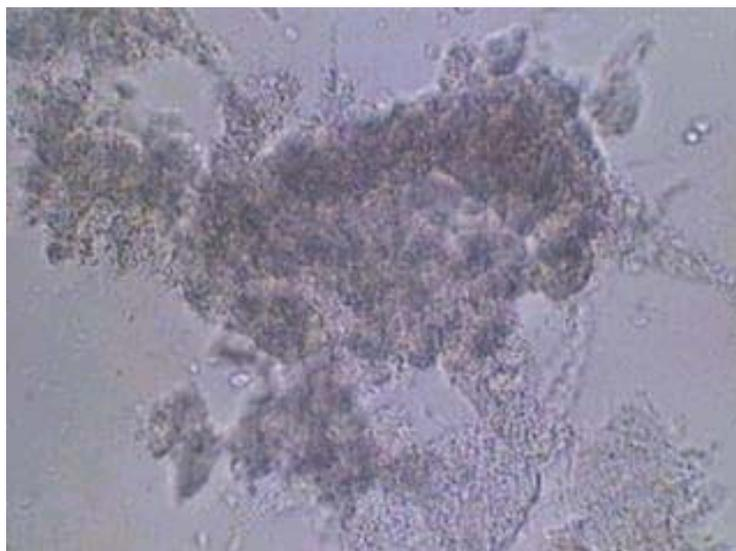
**Figura 5.12** : Lodo aclimatado com água residuária sintética com boas características, utilizado no experimento 02, onde se observa flocos de bactérias.
