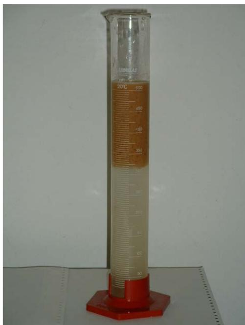
**Figura 5.3** : Lodo “flotado” devido à presença de microbolhas aderidas aos flocos dificultando a sedimentação para o cálculo do IVL.
