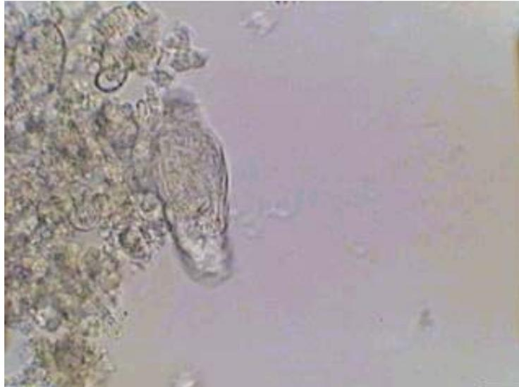
**Figura 5.6** : Lodo ativado pressurizado em boas condições, onde se observa um rotífero (*Ephifanes senta*) à esquerda do campo.
