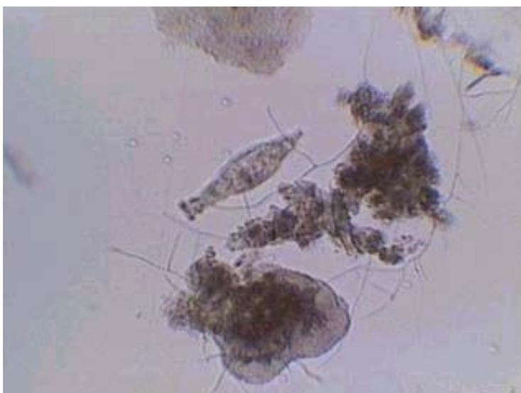
**Figura 5.19** : Lodo ativado com aspecto filamentosos após mudança na receita original da água residuária sintética, com um rotífero no centro do campo.
