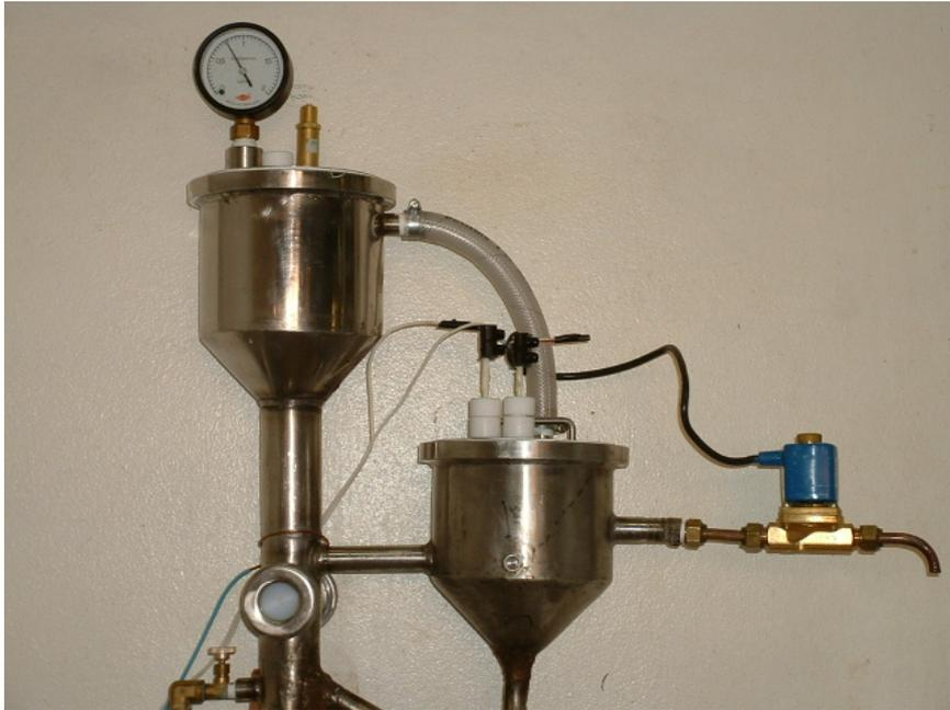
**Figura 4.3** : Detalhes do manômetro, válvula de segurança, sedimentador, tubo de equalização de pressão e sistema de controle de nível do reator “air-lift” pressurizado.
