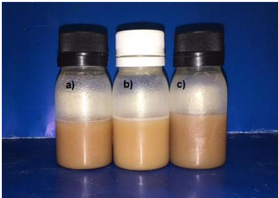
Figura 26 - Aparência das suspensões aquosas com: a) material pré tratado; b) nanofibras de celulose via oxidação catalítica; c) nanofibras de celulose via hidrólise ácida
