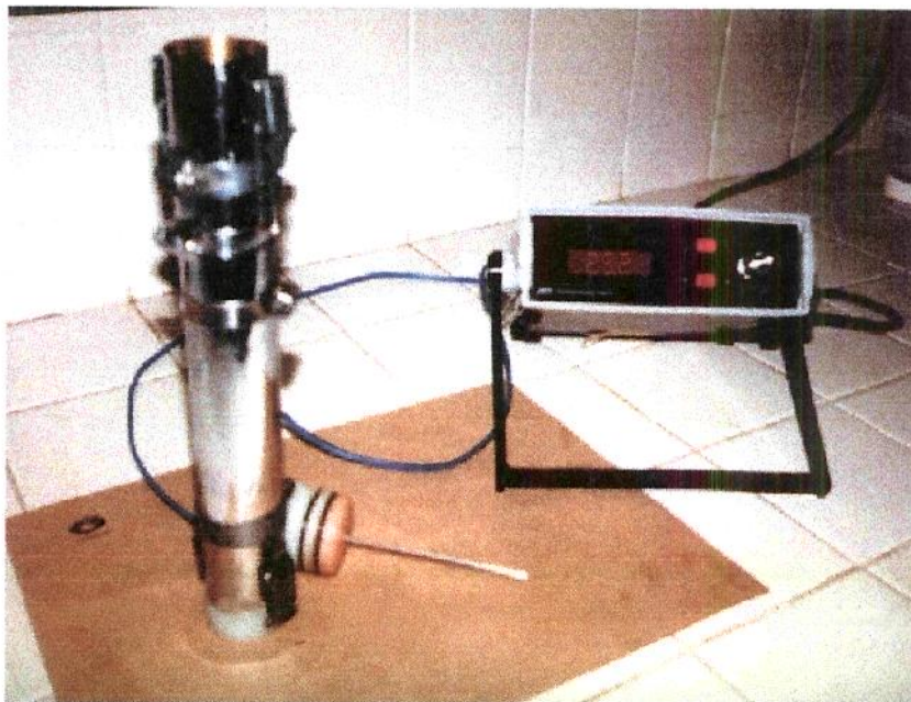
Figura 3.3. Cápsula utilizada na medida de difusividade térmica
