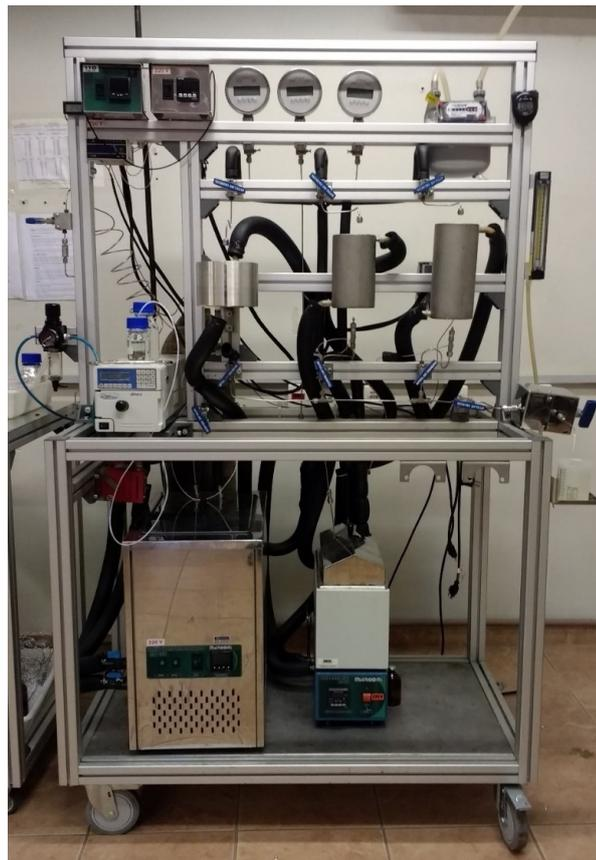
Figura 6. Unidade de extração construída no LAPEA.
