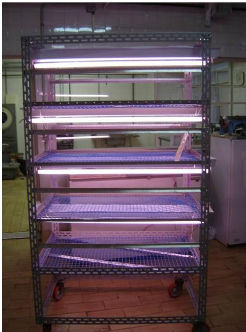
Figura 10 - Carrinho utilizado para testes em câmara fria
