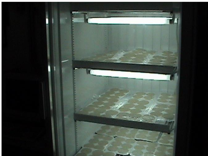
Figura 12 – BOD para experimento de descoloração
