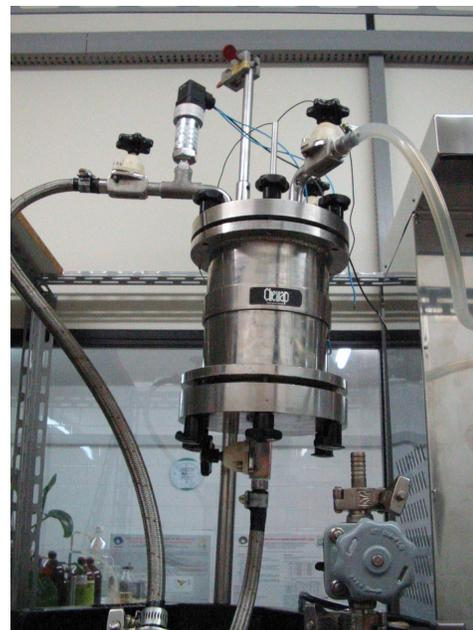
Figura I. 1 – Montagem e Instrumentação do Tanque *Flash*
