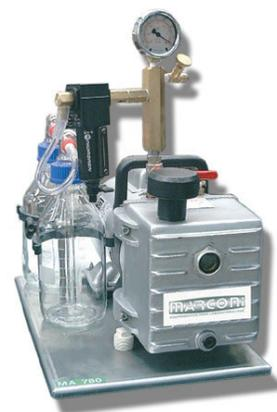
Figura I. 2 – Montagem e instrumentação do sistema de vácuo
