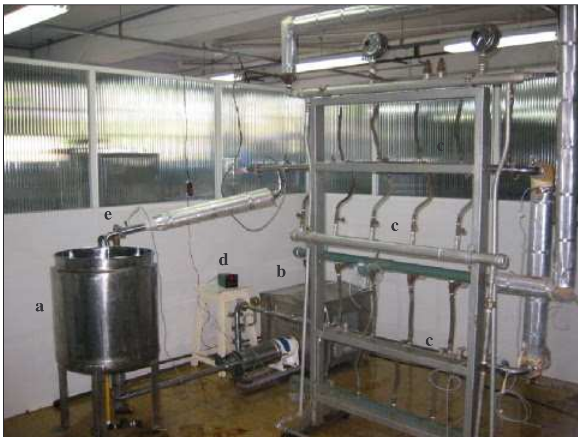
Figura 2 - Equipamento utilizado no processamento contínuo de doce em massa
