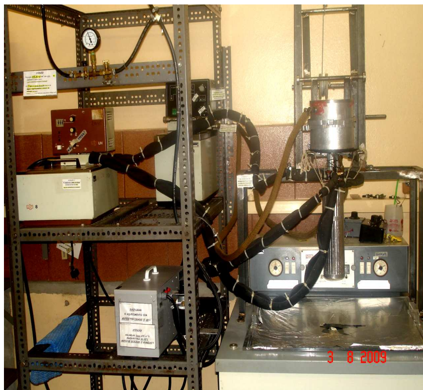
Figura 1. Foto da montagem do equipamento " Spray Chilling " para a produção de micropartículas lipídicas.
