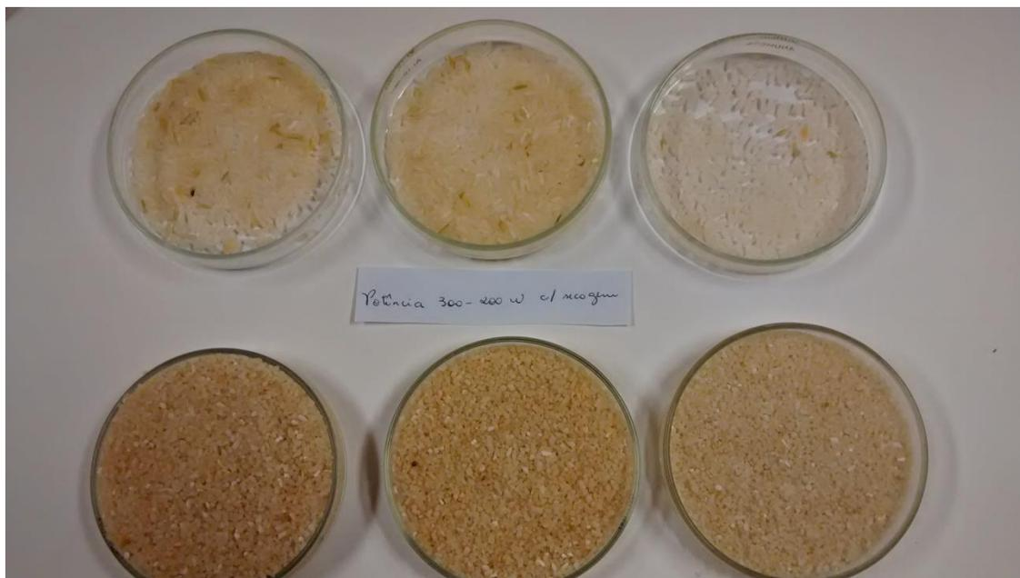
Figura 20. Arroz beneficiado após tratamento térmico (TT4) em triplicata, seguido pela secagem simultânea de ar quente e micro-ondas. Placas superiores correspondem aos grãos inteiros e as placas inferiores aos grãos quebrados.
