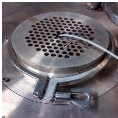
Figura 4. Tampa da cavidade de micro-ondas fixada por abraçadeira, posicionada sobre a parte metálica do cesto. Ao centro da tampa está fixada a fibra óptica destinada à aferição da temperatura do arroz em casca.
