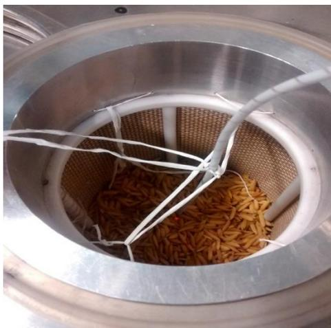
Figura 5. Cesto de teflon posicionado na cavidade de micro-ondas, contendo metade da amostra (100 g). Ao centro está posicionada a fibra óptica responsável pela aferição da temperatura do material.
