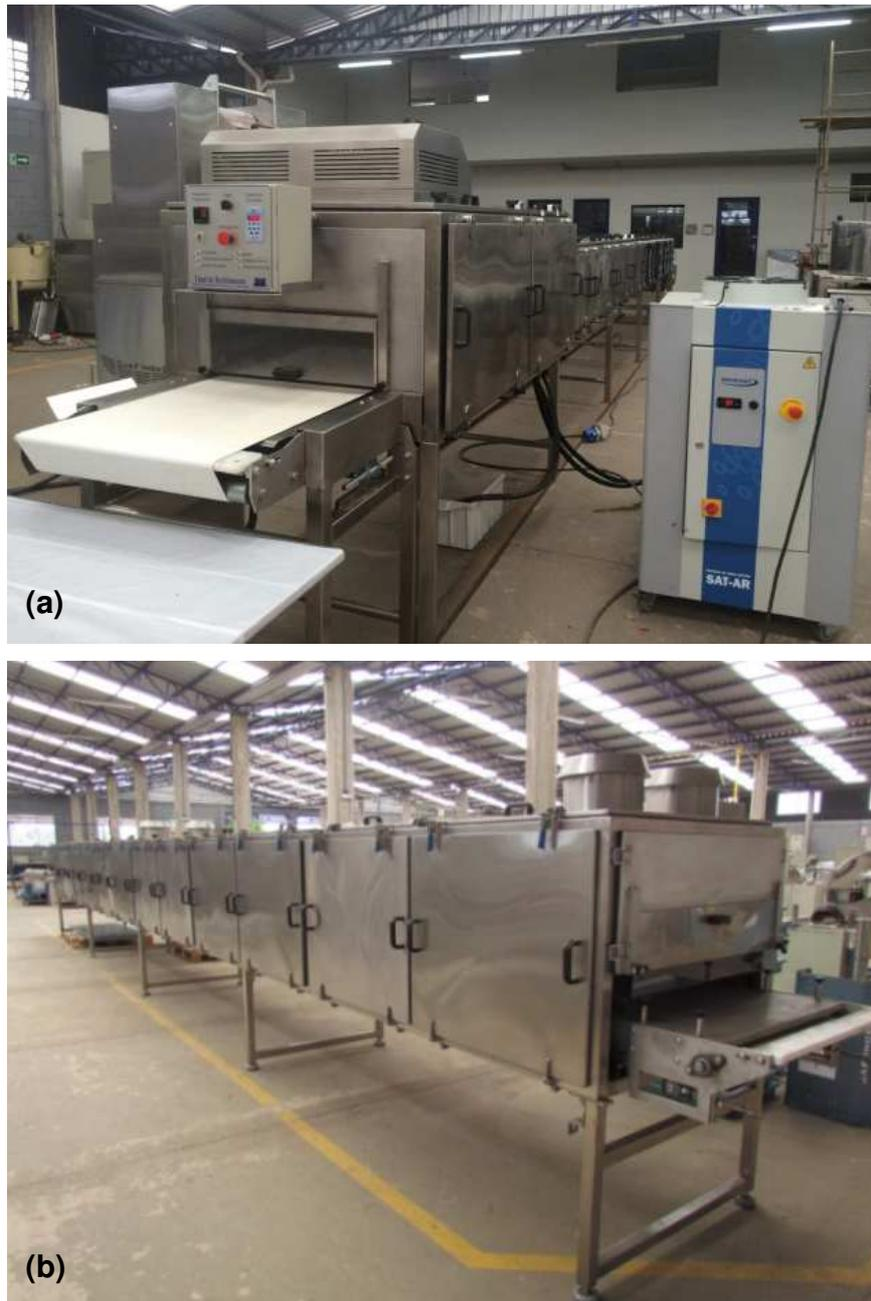
**Figura 6.** Túnel de resfriamento de troca indireta Jafinox, utilizado para os testes deste estudo, visão frontal (a) e saída do túnel (b).
