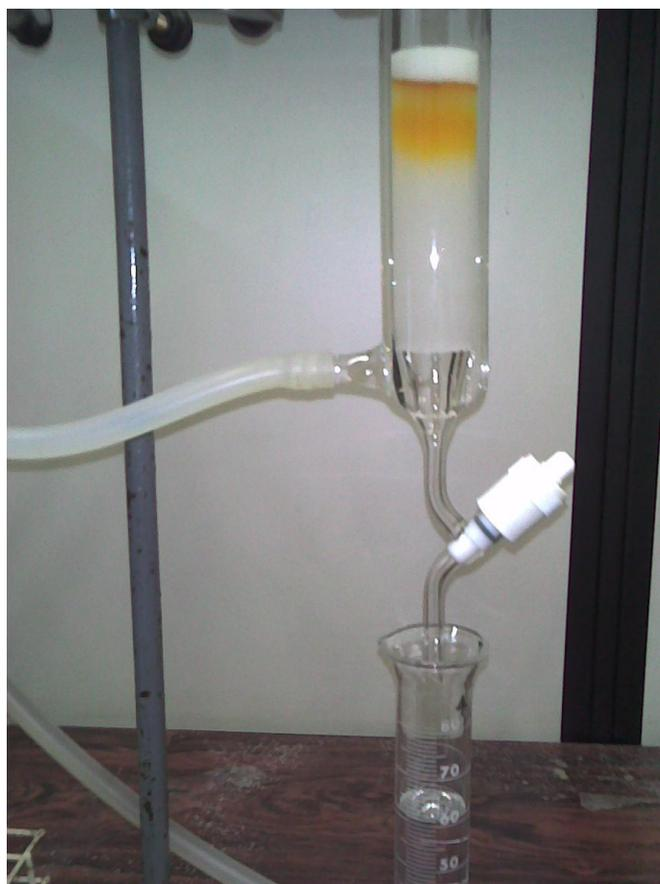
**Figura 5.** Eluição de amostra por cromatografia em coluna aberta.
