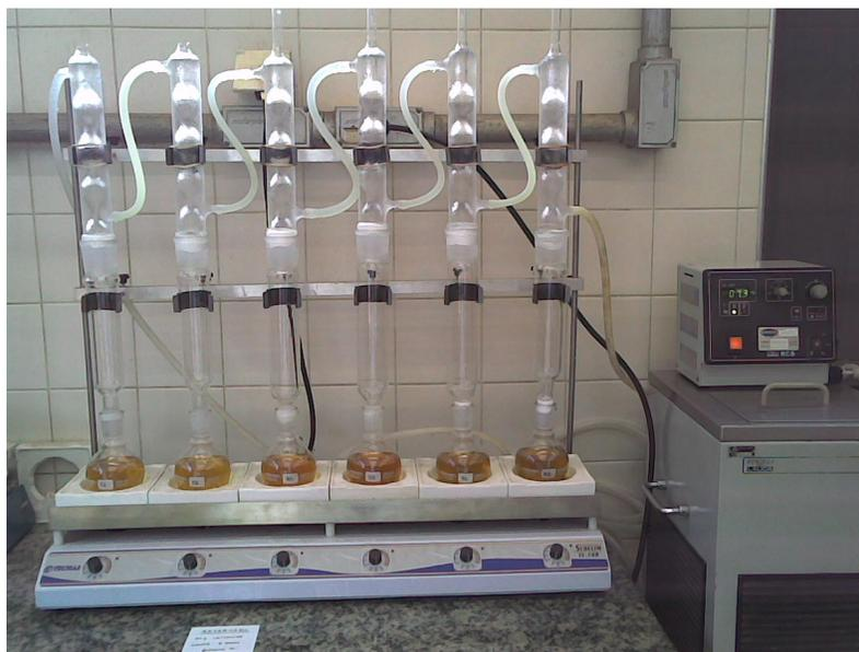
**Figura 3.** Saponificação da amostra sob refluxo.
