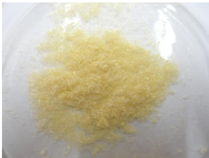
**Figura 5.25 Cristais de ácido kójico formados na cristalização com sistema anti-solvente**
