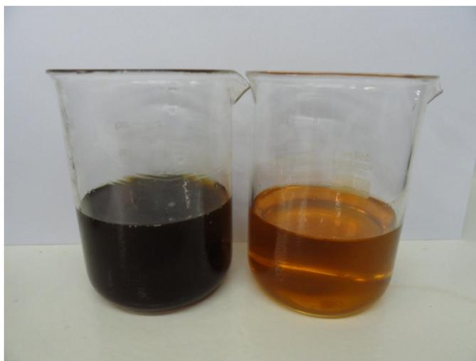
Figura 5.20 Comparação Glicerol bruto (esquerda) vs Glicerol parcialmente purificado (direita)
