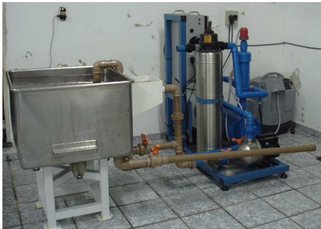
Figura 2.1 – Equipamento gerador de água ozonizada.
