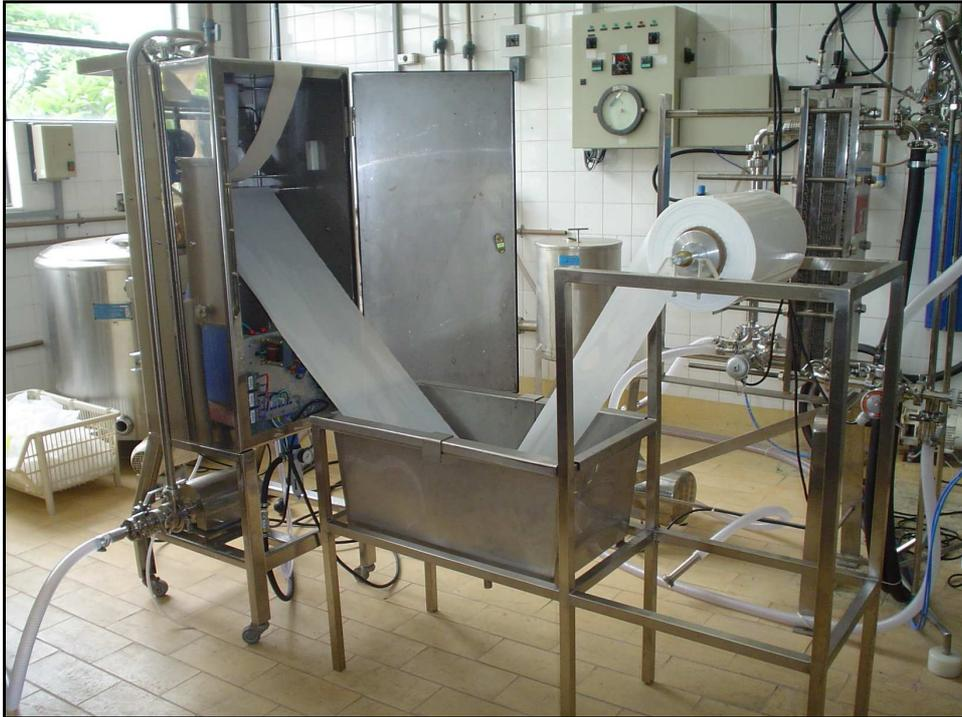
**Figura 9** – Sistema de esterilização de filme de PEBD, com H<sub>2</sub>O<sub>2</sub> e radiação UV.
