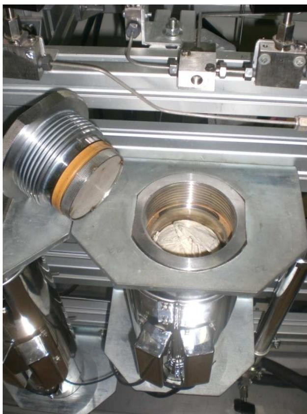
**Figura 16** - Extrator com a célula de nylon empacota com cravo.
