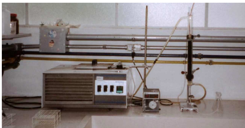
Figura 5: Foto da montagem experimental do leito de inulinase imobilizada.
