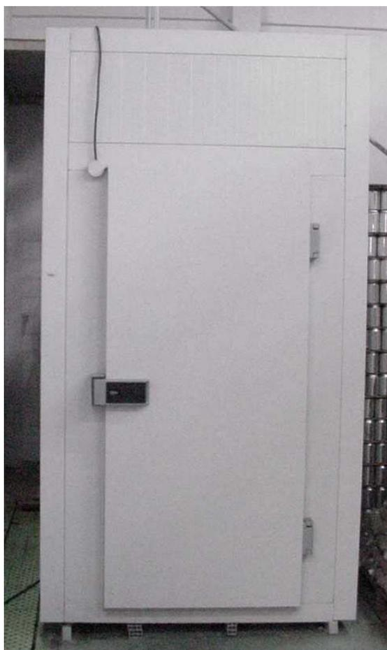
Figura 5 – Câmara fria (marca Kit Frigor) utilizada para congelamento a  $-20^{\circ}\text{C}$  dos concentrados protéicos de soro para liofilização.
