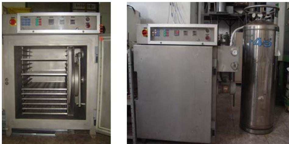
**Figura 3.5:** Gabinete de congelamento utilizado como equipamento para o congelamento rápido.
