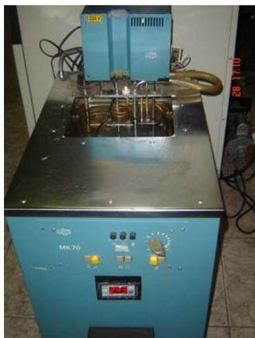
**Figura 3.3:** Banho termostático utilizado para a calibração dos sensores de temperatura.
