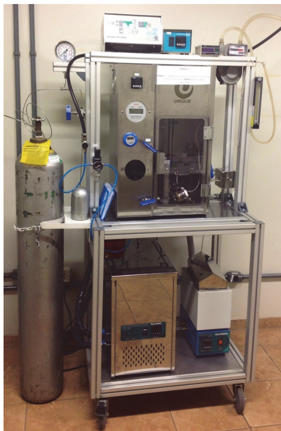
Figura 4.4 Unidade de extração supercrítica assistida por ultrassom.
