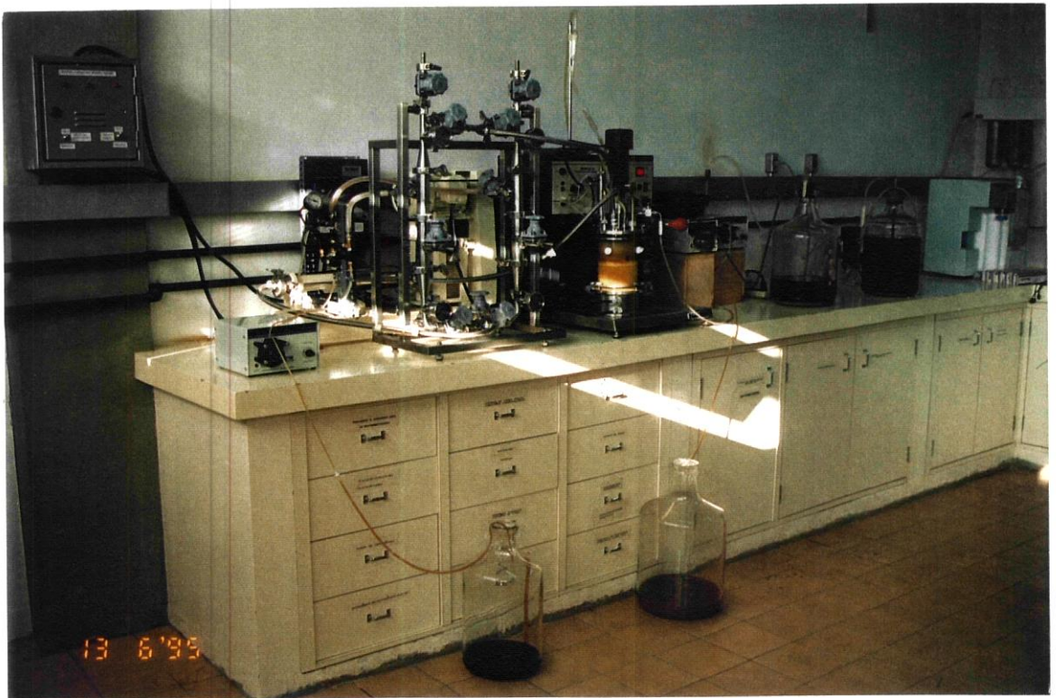
Figura 3.5 : Visão lateral do conjunto fermentador/microfiltro.
