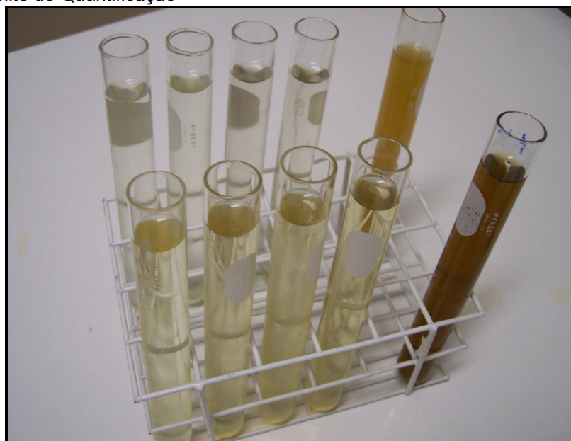
Figura 2-7 – Amostras de melaço (frente) e água de maceração de milho (fundo) após 10, 20, 30 e 40 minutos de pré-tratamento e sem pré-tratamento, respectivamente.
