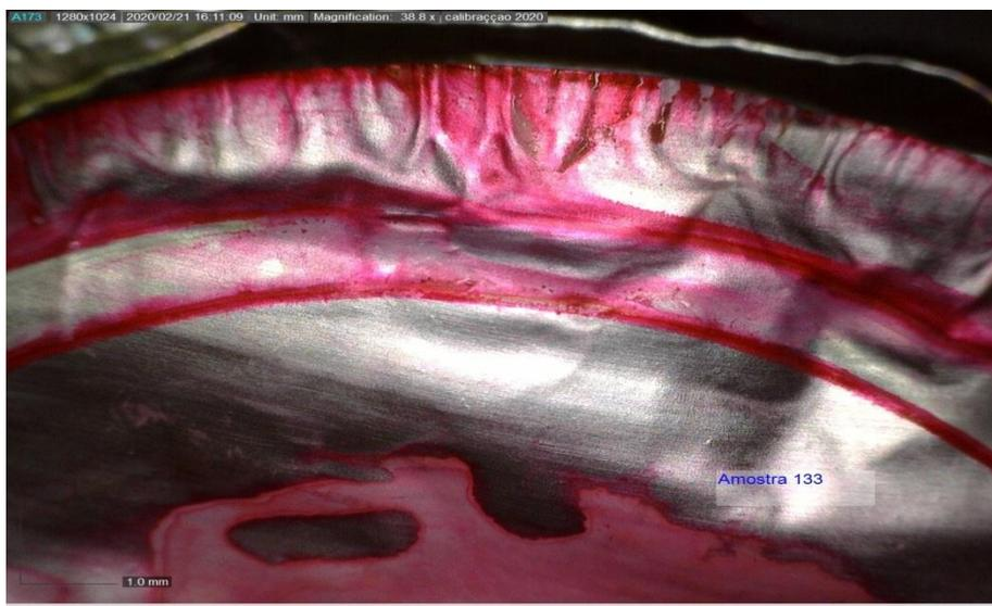
Figura X: Resultado do teste de corante da AMOSTRA 133.
