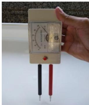
Figura 7 - Inserção dos dois eletrodos do amperímetro na solução salina contida no recipiente de acrílico (autoria própria)
