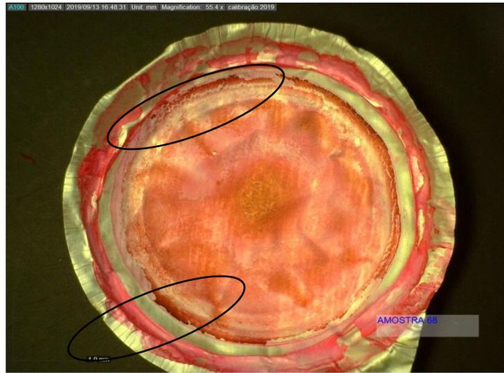
Figura IV: Resultado do teste de corante da AMOSTRA 68.
