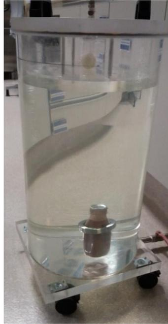
Figura 5 - Câmara de vácuo (preenchida com água) com uma amostra acoplada à argola metálica (autoria própria)
