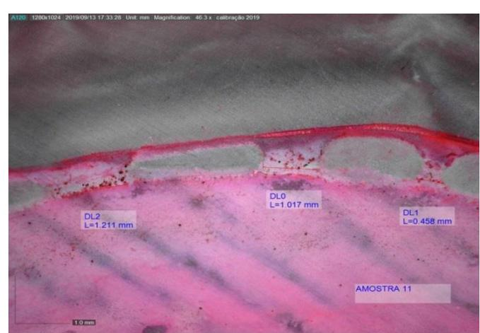
Figura VI: Resultado do teste de corante da AMOSTRA 11.
