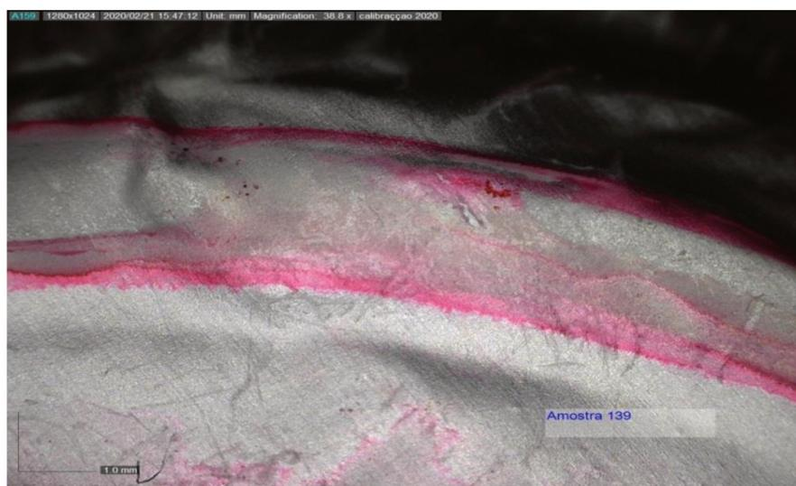
Figura IX: Resultado do teste de corante da AMOSTRA 139.
