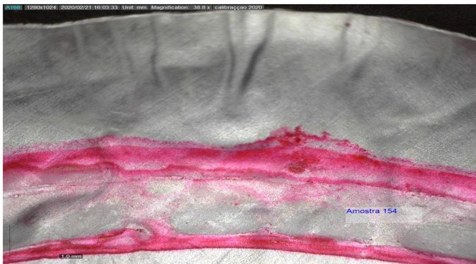
Figura XV: Resultado do teste de corante da AMOSTRA 154.
