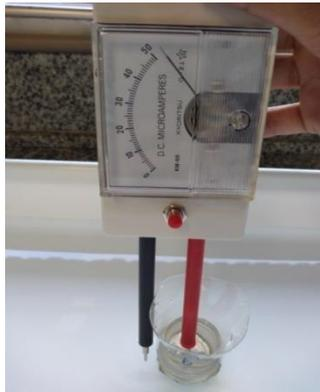
Figura 8 - Inserção de um eletrodo do amperímetro na solução salina contida na caixa de acrílico e o outro na solução salina contida dentro da amostra (autoria própria)
