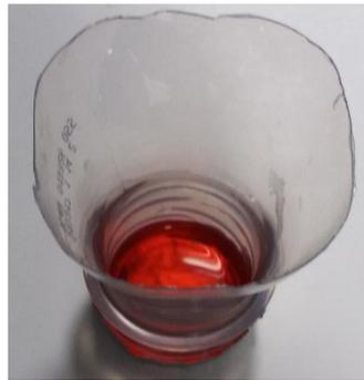
Figura 9 - Solução colorida adicionada na parte interna das amostras teste (autoria própria).
