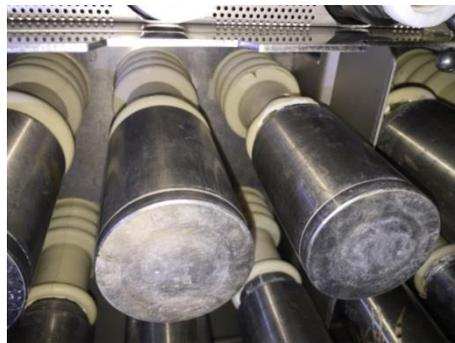
Figura 1 - Perfil da barra de aquecimento (autoria própria)
