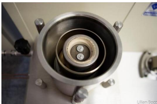
**Figura 12** - Disposição dos cadinhos juntamente com a esfera de tungstênio dentro da célula de pressão.
