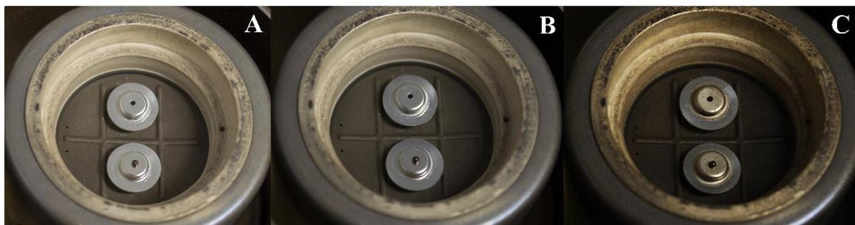
**Figura 16** - Comparação entre os testes com e sem fluxo de nitrogênio dentro da célula de pressão. (A) antes do aquecimento; (B) após o aquecimento com nitrogênio; (C) após o aquecimento sem nitrogênio.
