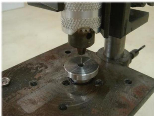
**Figura 6** - Sistema de perfuração: suporte de fixação, mandril e broca. (Fonte: Matricarde Falleiro, 2012.)
