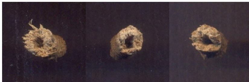
Figura 14 - Imagem da secção transversal dos extrusados – Delineamento A
