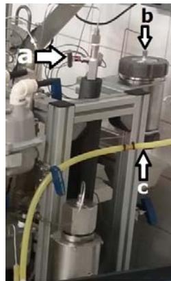
*Figura D. 5. Válvula de entrada de CO<sub>2</sub> do TP e conexões superior e inferior da AdC1.*
