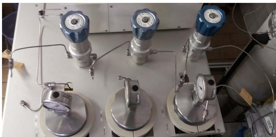
*Figura B. 1. Conexão entre válvulas backpressure para limpeza*
