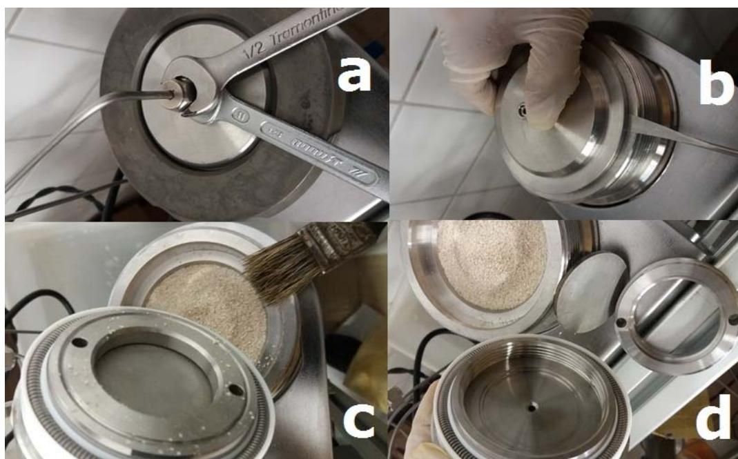
*Figura E. 3. Desmontagem da tampa superior da AdC1.*
