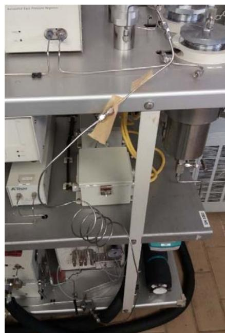
*Figura B. 2. Conexão da bomba de líquido com a válvula backpressure.*
