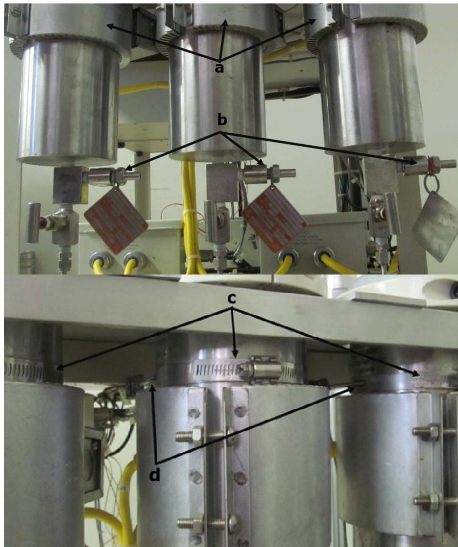
Figura A. 4. Configuração das mantas de aquecimento dos VS, válvulas de segurança e termopares.
