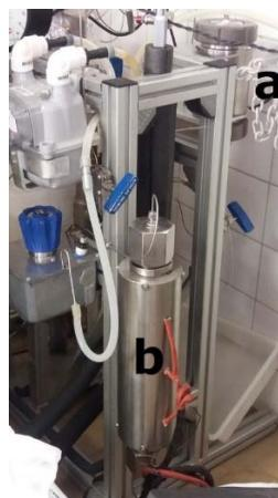
*Figura D. 6. Colunas de adsorção utilizadas no processamento pseudocontínuo, AdC1 (a) e AdC2 (b).*
