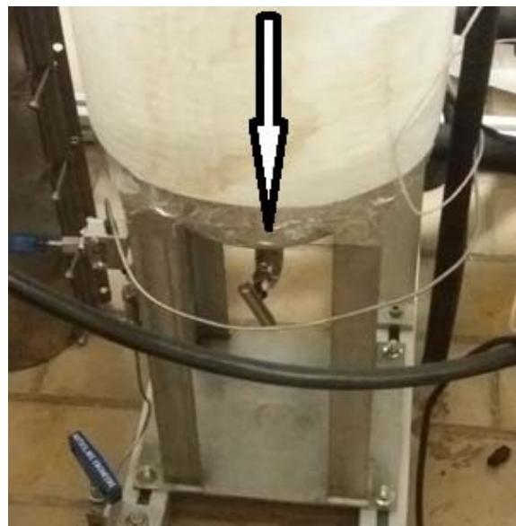
*Figura E. 9. Válvula de purga do TP.*
