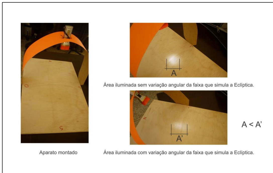
FIGURA 1 - APARATO PROPOSTO PARA OBSERVAÇÃO DA VARIACÃO DA INSOLAÇÃO, COM AS DIFERENÇAS DE ÁREAS ILUMINADAS.
