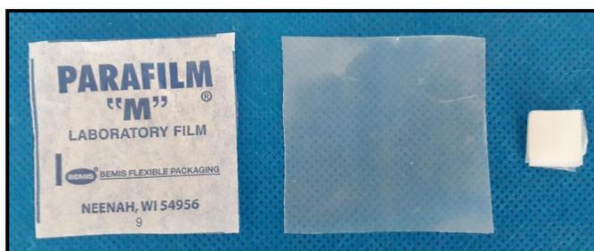
**Figura 11:** Parafilm® "M" cortado em barras e dobrado 4 vezes
