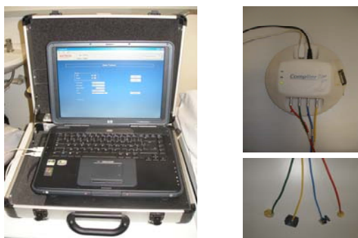
Figura 2: Equipamento automático Complior ® System (Artech-Medical, Pantin - France); cada sensor é utilizado em uma região arterial específica (verde-femoral, amarelo-distal, azul-radial, vermelho-carótida).
