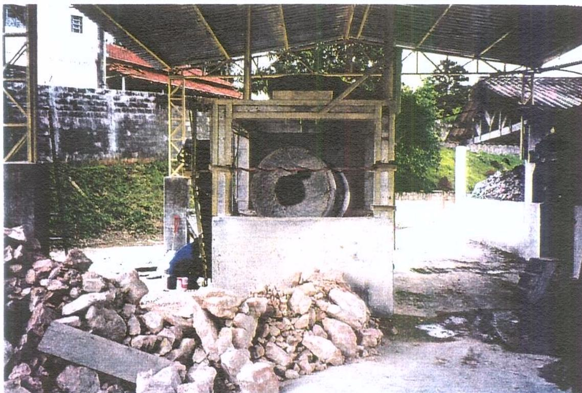
A argila é beneficiada na indústria através da diluição com água e separação das impurezas por peneiramento.
