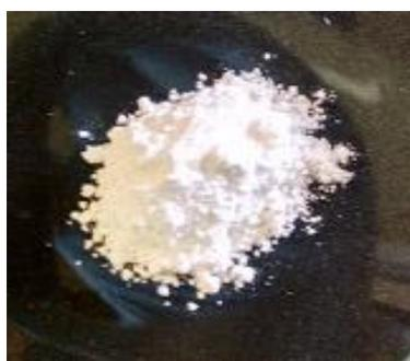
**Figura 8.** Micropartículas produzidas por *spray-drying*
