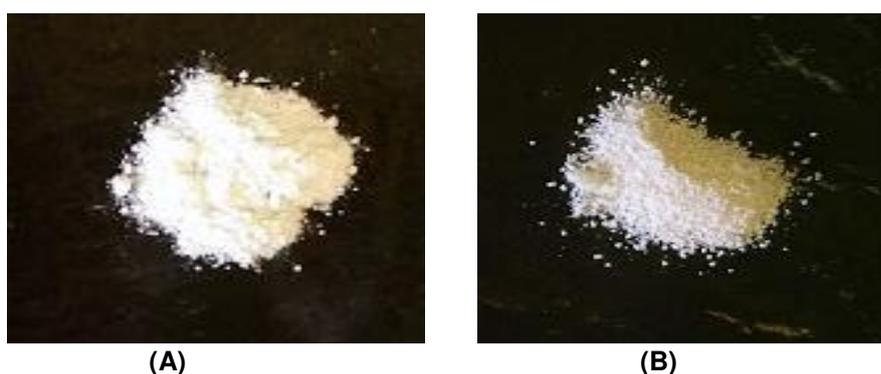
**Figura 6.** Grânulos obtidos por granulação via umida, secos em estufa (A) e dessecador (B)
