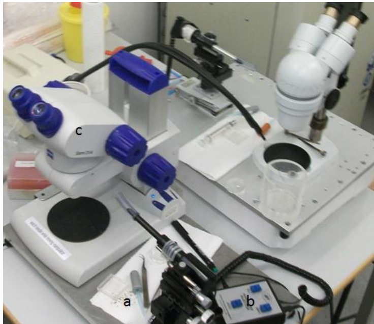
Figura 8: Bancada de injeção de cRNA em Oócitos de Xenopus laevis . a. Instrumentos para pegar os oócitos e peça de acrílico para esses manter-se imóveis, assim facilitar a injeção; b. Mecanismo para injeção da solução com o cRNA (47nL por oócito); c. Microscópio.
