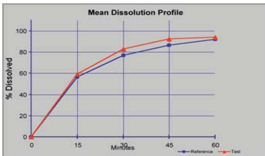
**Figura 8-** Perfil de dissolução entre duas formulações denominadas referência e teste (disponível em: [www.dissolutiontech.com](http://www.dissolutiontech.com)).
