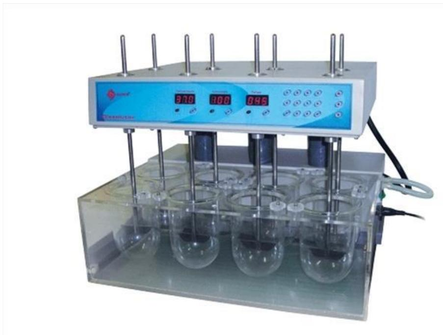
**Figura 7-** Dissolutor com 8 cubas apresentando o aparato 2 (pá) (disponível em: [www.ganalab.com.br](http://www.ganalab.com.br)).
