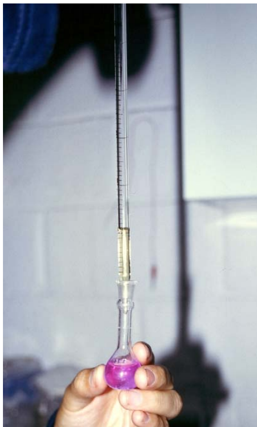
Figura 11- Adição de 2 ml do volume total recuperado (Volume B) para balão volumétrico de 10ml com solução de fosfato triassódico.
