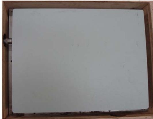
**Figura 18-** Plataforma de força.
