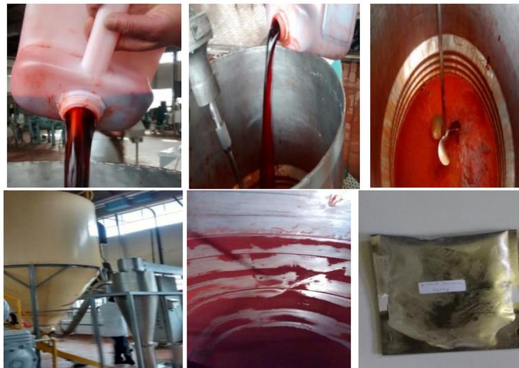
**Figura 6:** Secagem do extrato *A.chica* por *spray dryer* em escala semi-industrial
