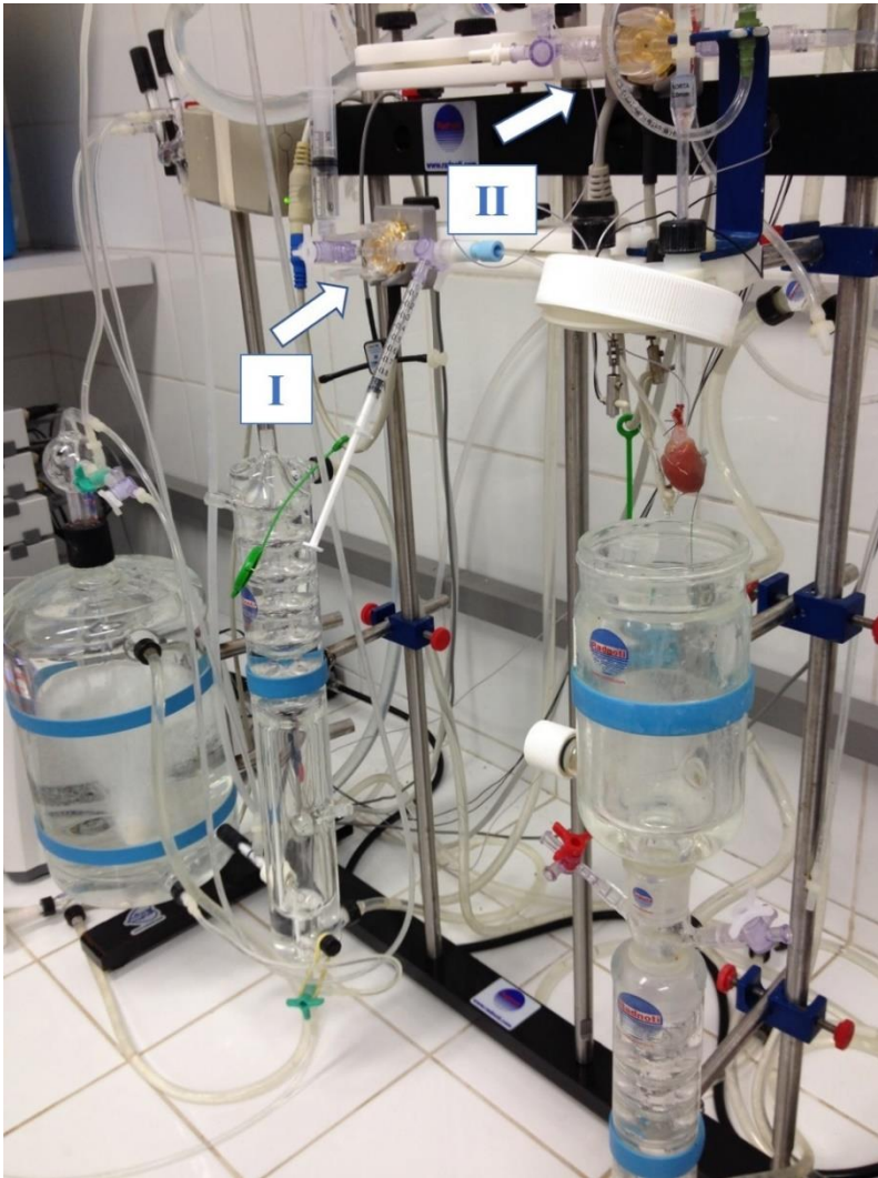
Figura 2: Sistema de perfusão: transdutores de pressão (I) intraventricular e (II) perfusão.
