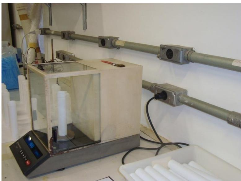
FIG. 04: balança de precisão.
