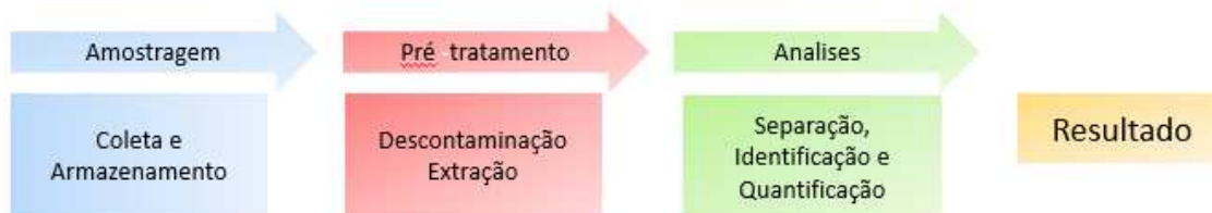
Figura 5. Fluxograma das etapas envolvidas no desenvolvimento de um procedimento para análise quantitativa.
