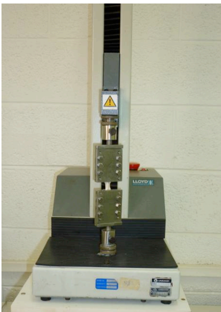
Figura 7. Corpo de prova fixo entre o sistema de garras e acoplado a prensa.
