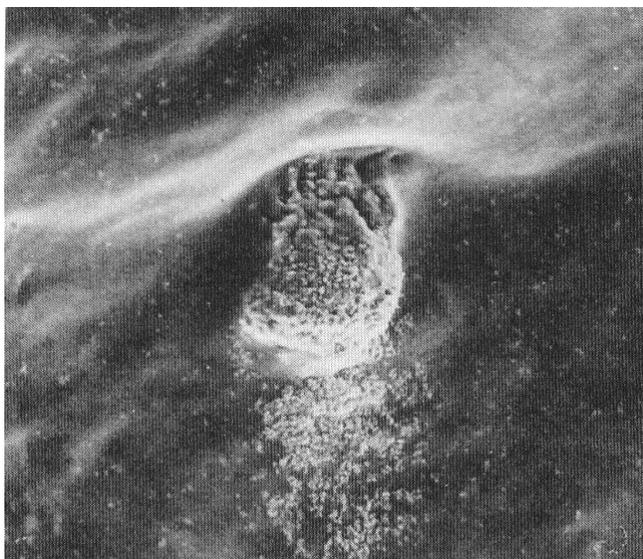
**Figura 4**-O exame por ME da figura 3 ampliado (x 730) mostra que os corpos de protrusão parecem estar irregularmente distribuídos ao longo da superfície interna do tubo e que podem ser grânulos de látex devido a um defeito na polimerização ocorrido durante o processo de produção.
