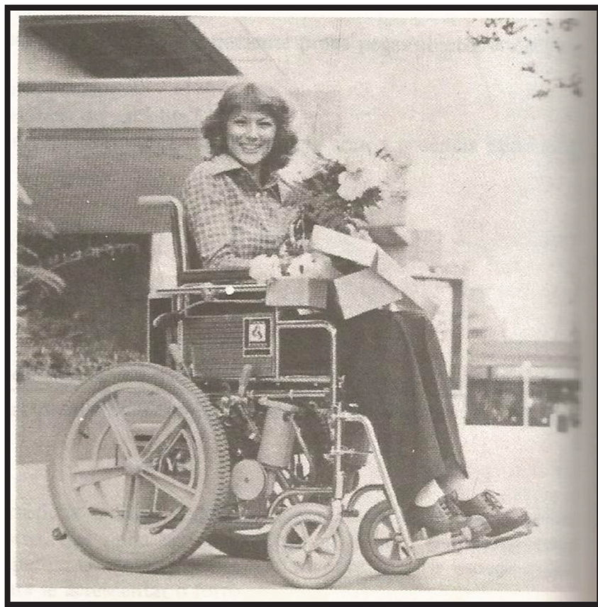
Figura 2: Cadeira de rodas motorizada e controlada por Joystick 20
