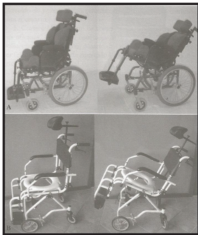
Figura 8: Cadeira de rodas manual padrão (imagem A) e de banho (imagem B) com função Tilt 18
