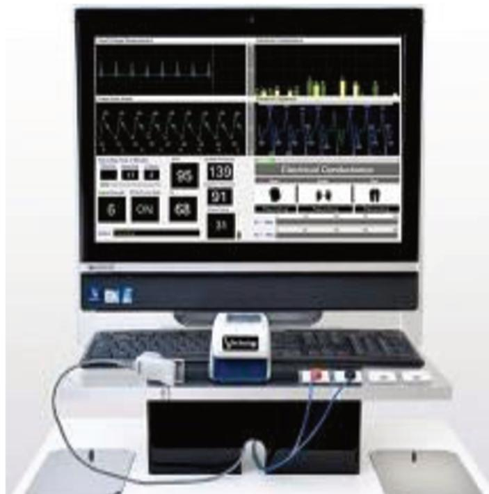
**Figura 1** – EsComplex – dispositivo utilizado na análise fotopletismográfica. Integração do oxímetro de pulso com o software computacional.
