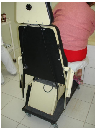
Figura 45 - Cadeira de dentista em frente ao tanque “lava pé”, adaptada ao “suporte com rodas”
