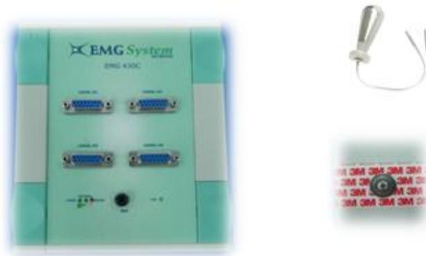
**Figura 4** – Equipamento de eletromiografia *EMG System do Brasil*®- EMG-430C; Eletrodo de superfície, adesivo, descartável; Sensor endovaginal *Physio Med Services*®; Fonte: Dados do pesquisador.
